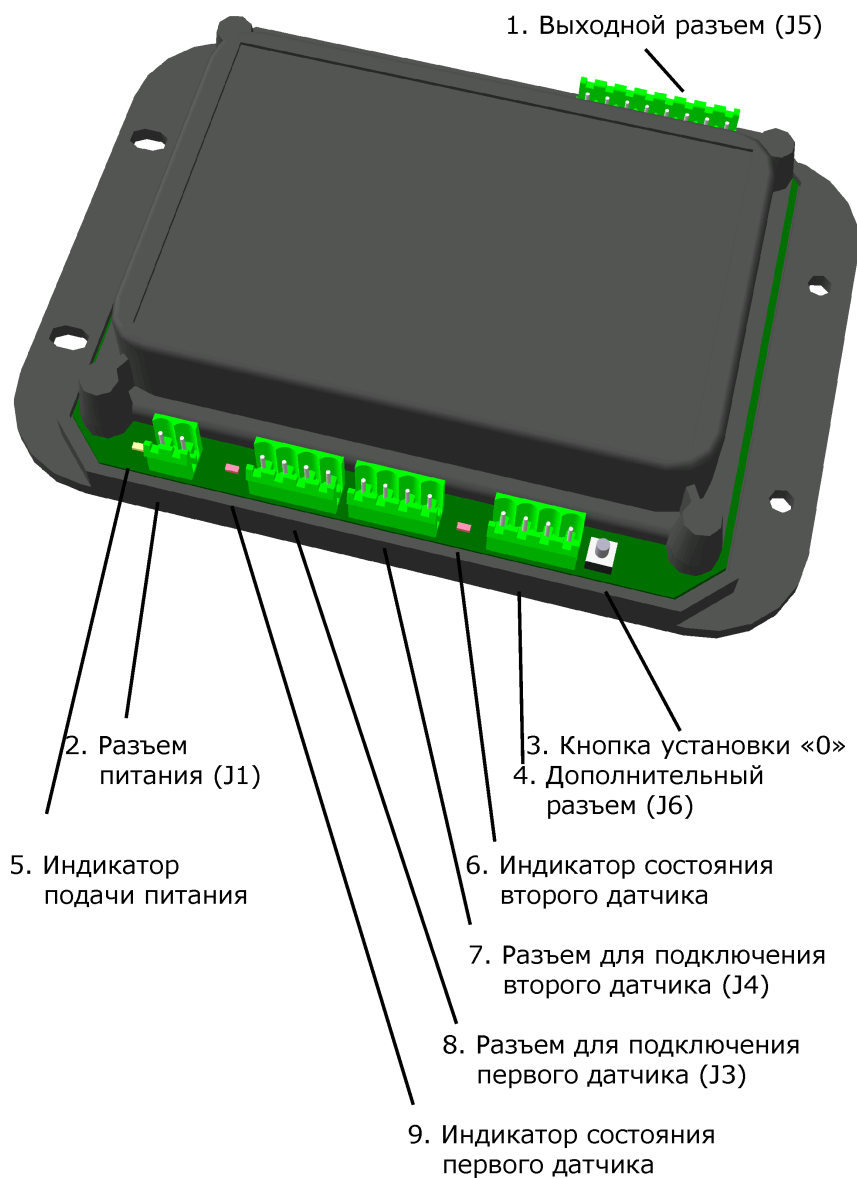
Рис. 3: Общий вид блока логики УКП ПС70
